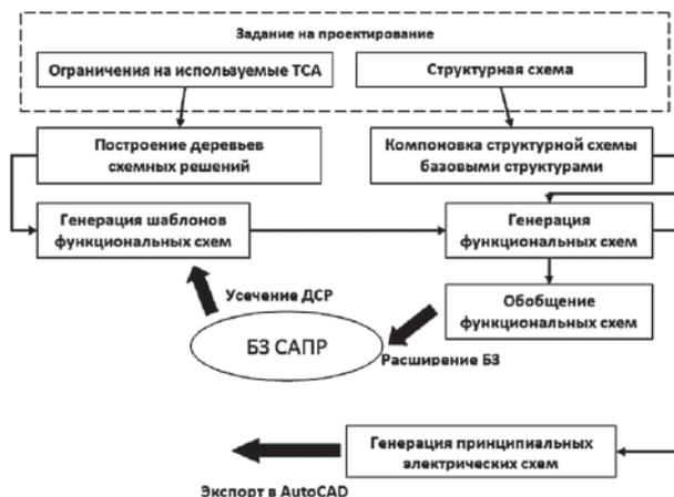
Например, необходимо спроектировать схему управления задвижкой трубопровода с использованием механизма электрического однооборотного (МЭО) на основании показаний датчика температуры (ТСМ9620). Предусмотрено наличие контура сигнализации обрыва линии подключения датчика. Управление МЭО осуществляется без использования датчиков положений. На рисунке 3 представлена структурная схема указанной системы управления.
